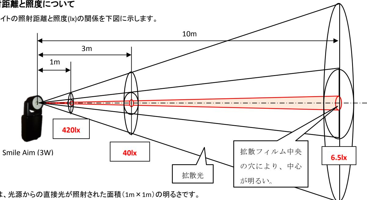
※照度は、光源からの直接光が照射された面積(1m×1m)の明るさです。
